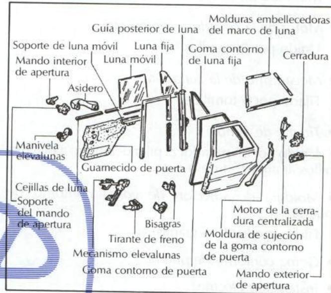
Fig. 28—Elementos de la puerta trasera.
