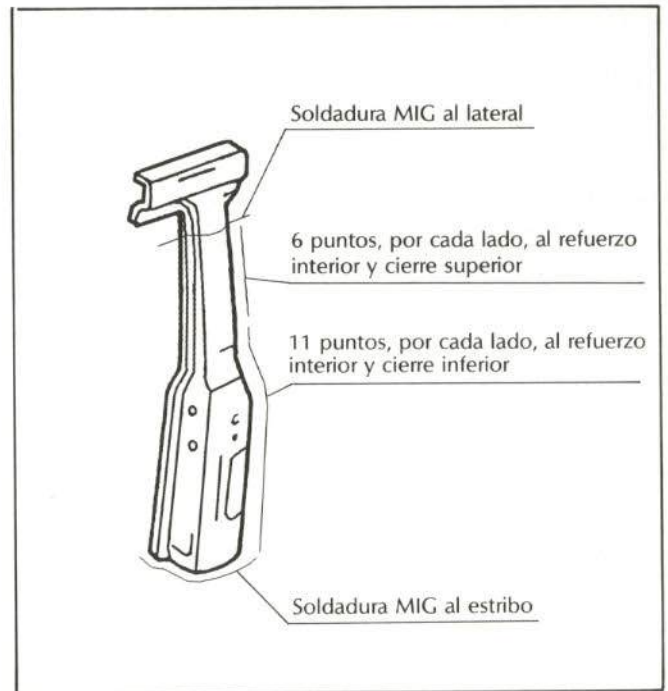
Fig. 38.—Unión del pilar central.
