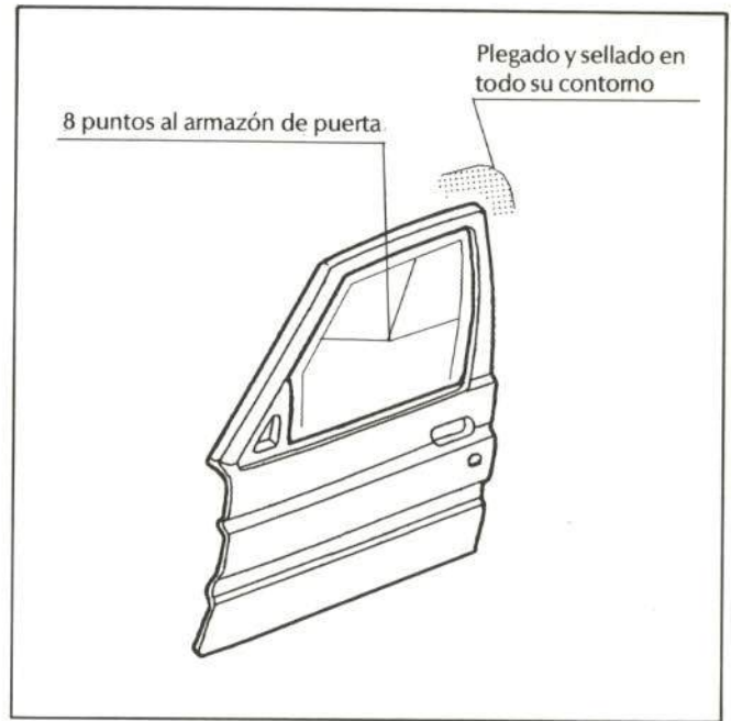
Fig. 27.—Unión del panel de puerta delantera.
