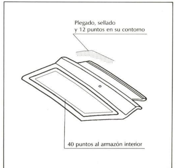
Fig. 59—Unión del portón trasero.
