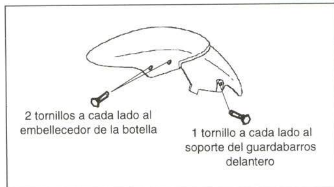
Figura 29.- Unión del guardabarros delantero
