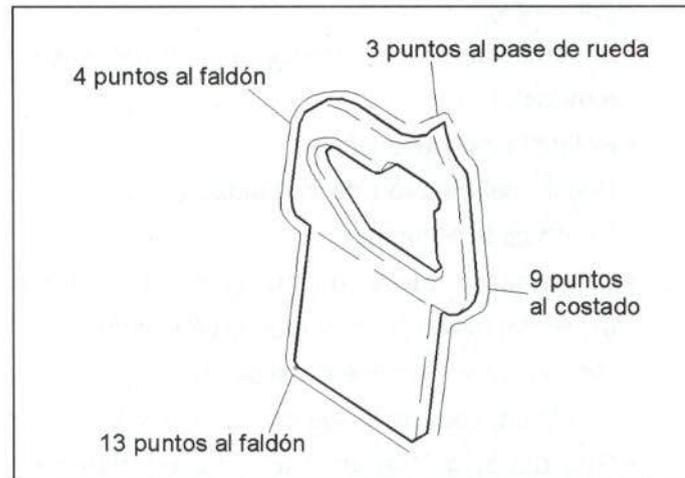
**Figura 42.** - Unión de la chapa portapiloto
