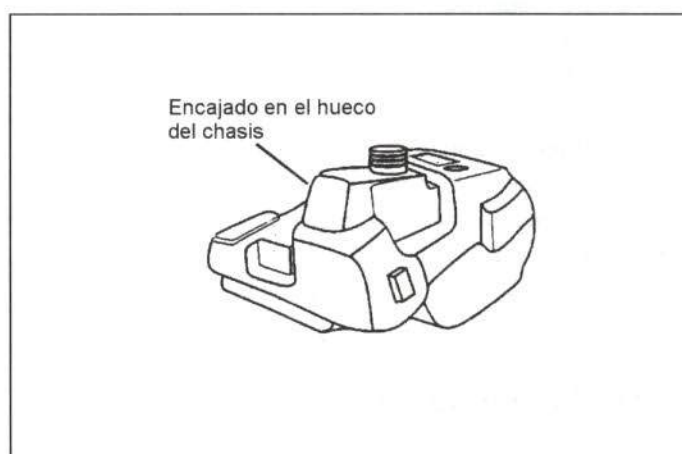
Figura 23.- Unión del depósito de combustible
