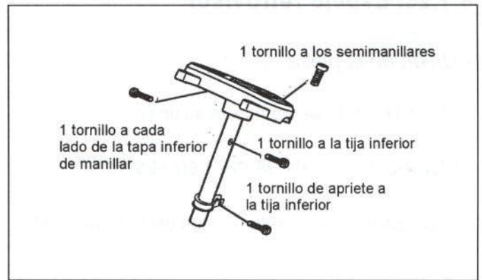
Figura 42.- Unión de la tija superior
