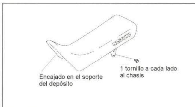
Figura 17.- Asiento del conductor
