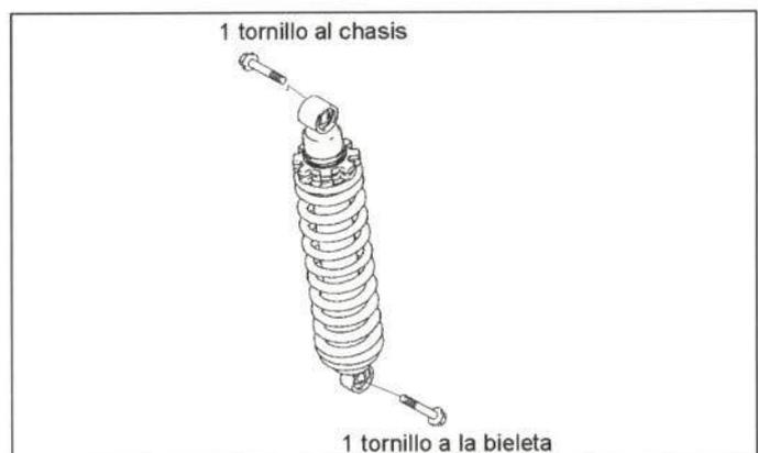
**Figura 28.-** Unión del amortiguador trasero
