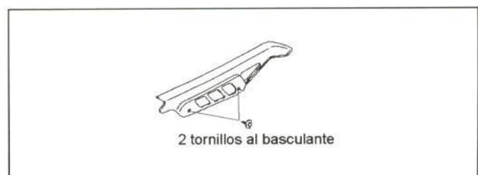
**Figura 29.-** Unión del cubrecadenas
