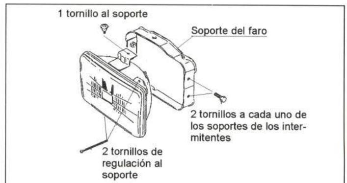
**Figura 32.-** Unión del faro delantero
