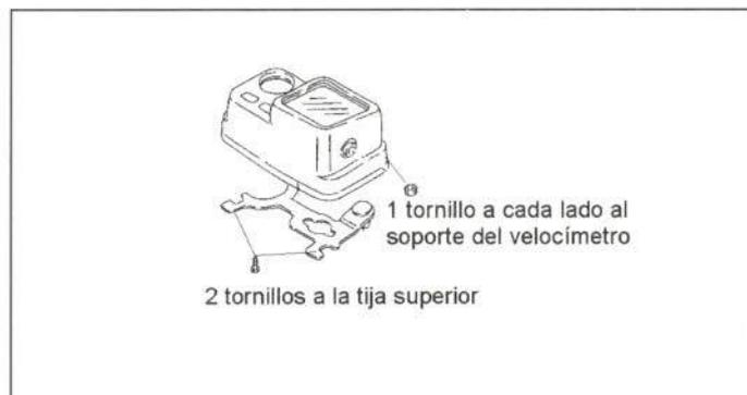
Figura 33.- Unión del velocímetro
