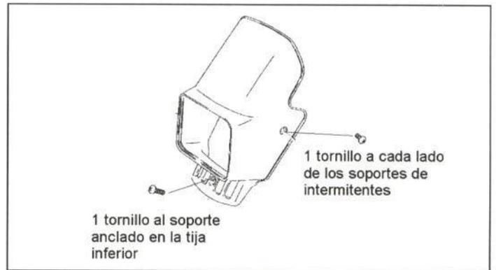
**Figura 31.-** Unión del carenado del faro delantero
