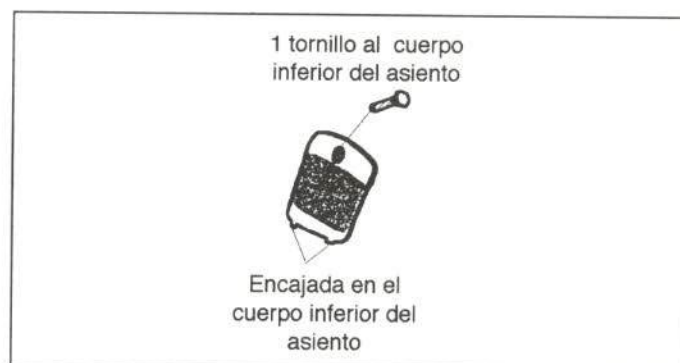
Figura 19.- Unión de la tapa de acceso a la bujía
