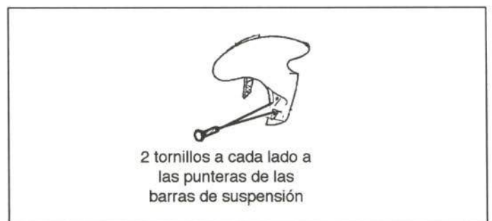
Figura 33.- Unión del guardabarros delantero
