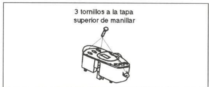
Figura 41.- Unión del velocímetro
