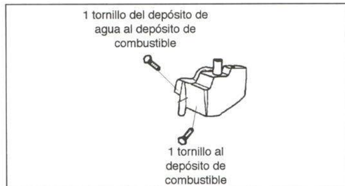
Figura 27.- Unión del depósito de aceite
