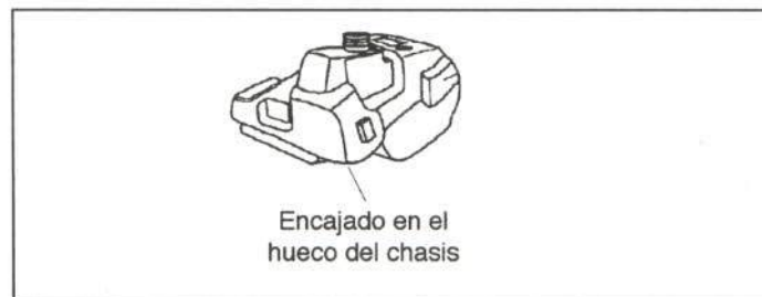
Figura 28.- Unión del depósito de combustible
