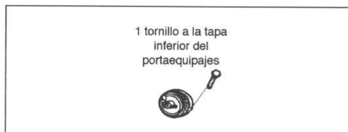
Figura 21.- Unión del intermitente trasero
