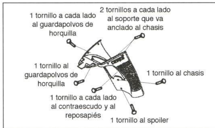
Figura 37.- Unión del guardabarros delantero superior
