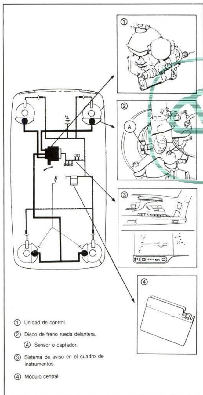
El sistema SCS (Stop Control System) incorpora un mecanismo, especialmente estudiado para vehículos de tracción delantera con circuito de frenos en X, (disposición del doble circuito de frenos en diagonal).
