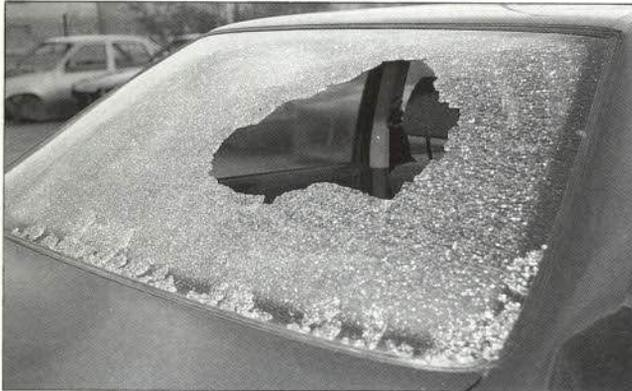
Las lunas laminadas están formadas por una capa de material plástico colocado entre dos láminas de vidrio. La rotura por impactos de piedras u otros objetos se produce en forma de grietas o estalladuras, que incluso pueden ser reparadas, siempre y cuando reúnan una serie de condiciones en cuanto a: magnitud de la estalladura, longitud de la grieta y localización. La reparación consiste fundamentalmente en la inyección de una resina de características especiales.
