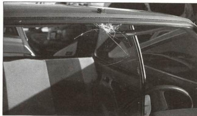
Las lunas templadas son aquellas que constan de una sola lámina de vidrio, que, tras un tratamiento especial, llegan a adquirir mayor resistencia que las ordinarias. En caso de impacto, estas lunas se fraccionan casi instantáneamente en trozos muy pequeños, impidiendo completamente la visibilidad del conductor. Este inconveniente se ha superado llevando a cabo un temple diferenciado, de forma que, en caso de rotura, la zona de visibilidad del conductor se fracciona en pedazos más grandes.
