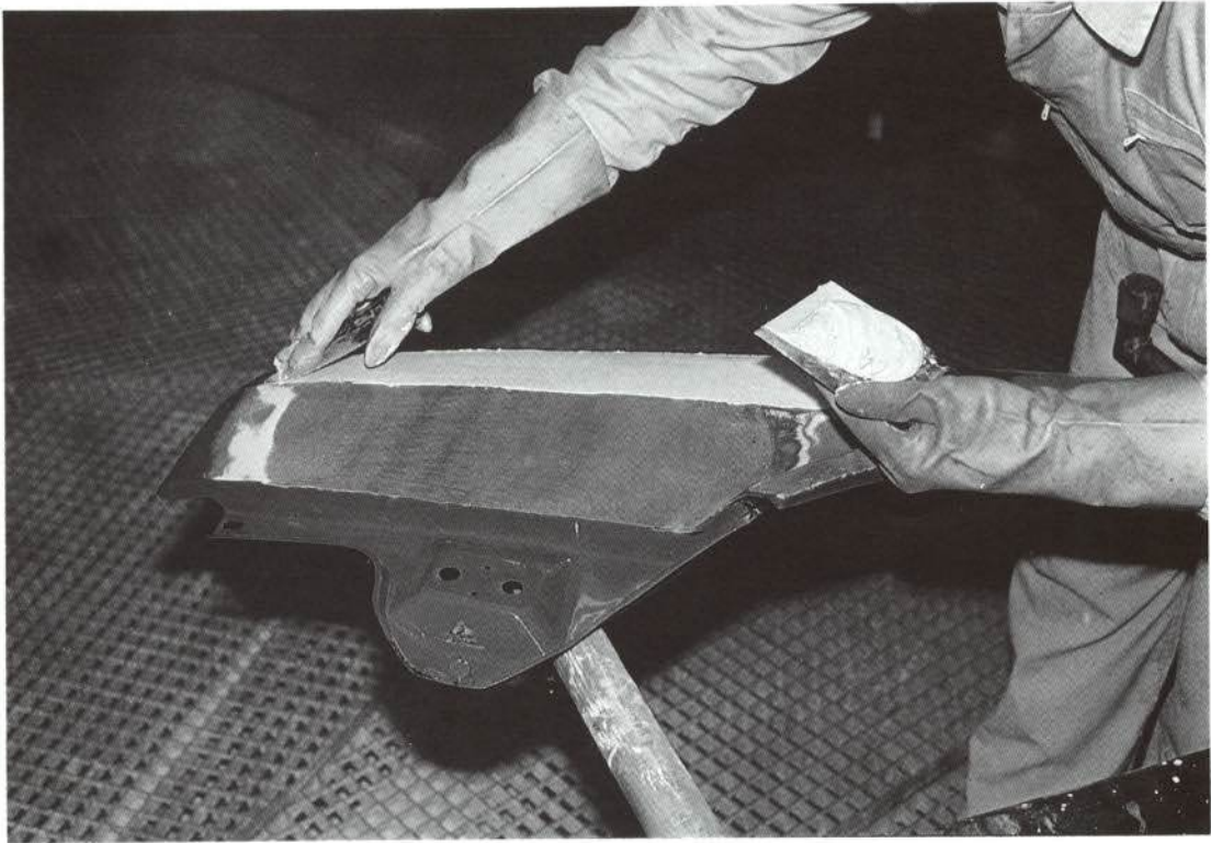
FIGURA 2.—Aplicación de masilla con espátula.
