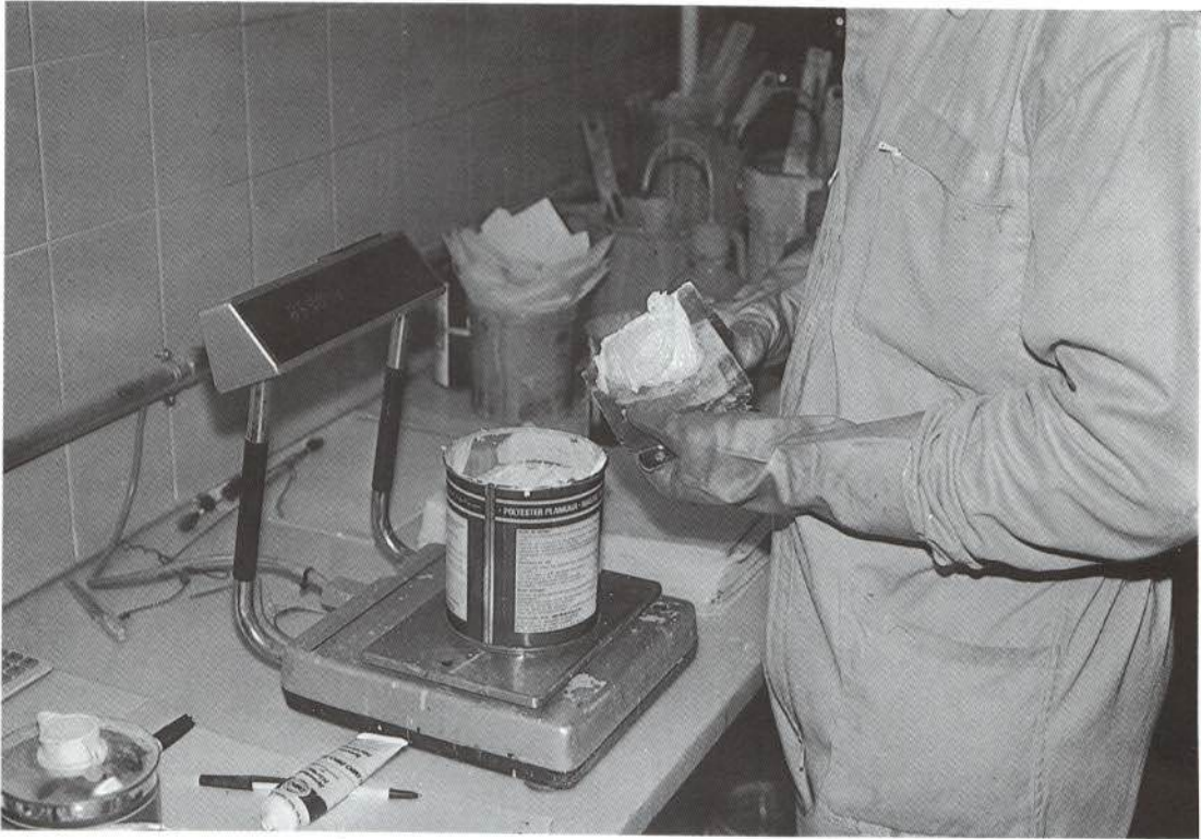
FIGURA 1.—Preparación de la masilla de poliéster.
