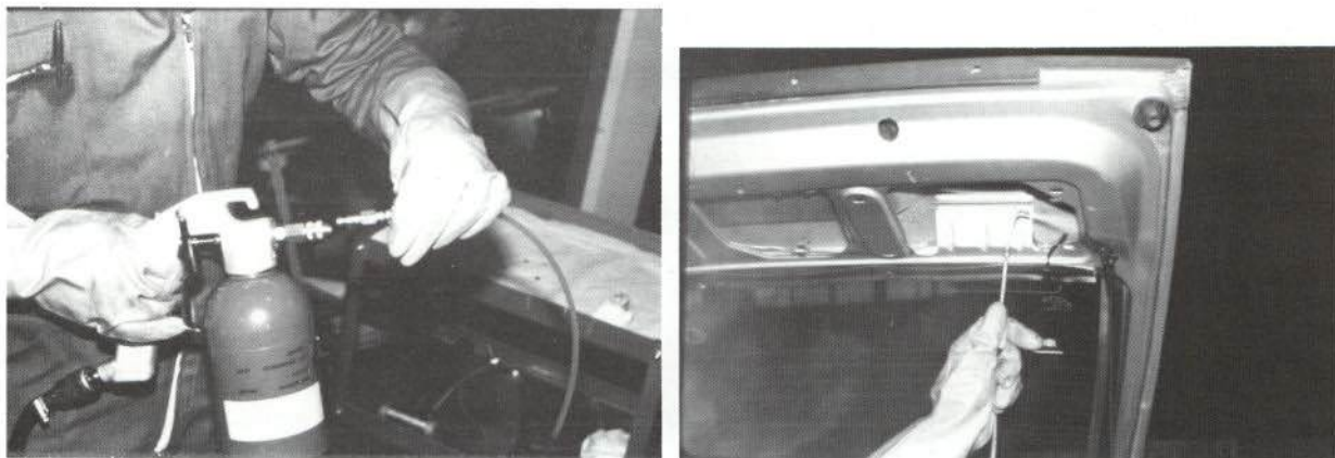
FIGURA 6.—Acoplamiento y pulverización con sonda de gancho.
