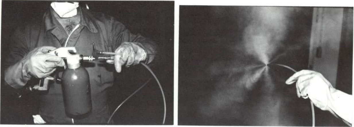
FIGURA 7. —Acoplamiento y pulverización con sonda flexible con surtidor radial de 360°.
