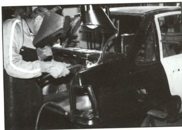
FIGURA 5.—Puesto de soldadura con extractor.
