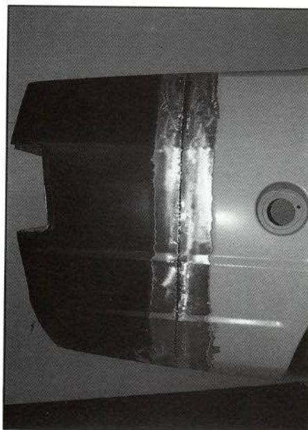
FIGURA 1. —Costura soldada para rellenar con estaño-plomo.
