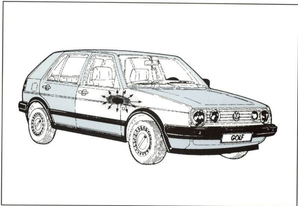
Figura 3.—Difuminado en puerta y aleta.
