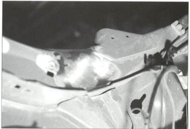
**Figura 3.**—Acabado con estaño-plomo en la reparación de un larguero.
