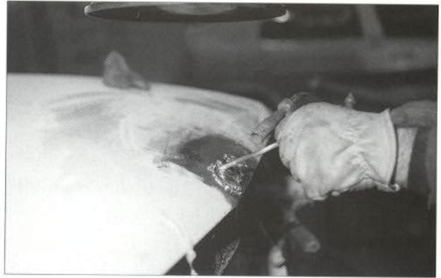
**Figura 2.**—Aplicación de estaño-plomo en la reparación de un capó delantero
