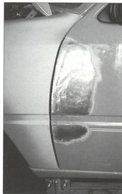
**Figura 4.**—Reparación de una puerta terminada con estaño-plomo.
