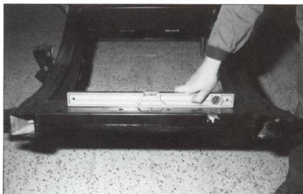
Figura 6.-Comprobación de nivel.
