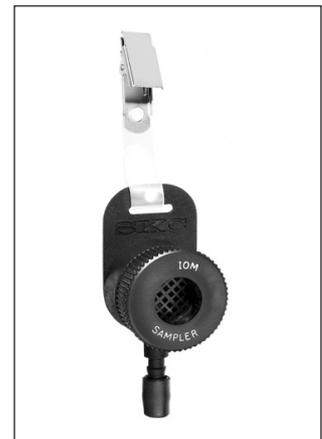
Figura 1. Muestreador IOM de plástico
