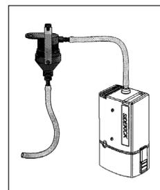
Figura 7. Conexión calibración bomba
