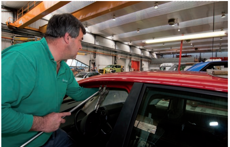
Reparación utilizando técnicas de empuje
