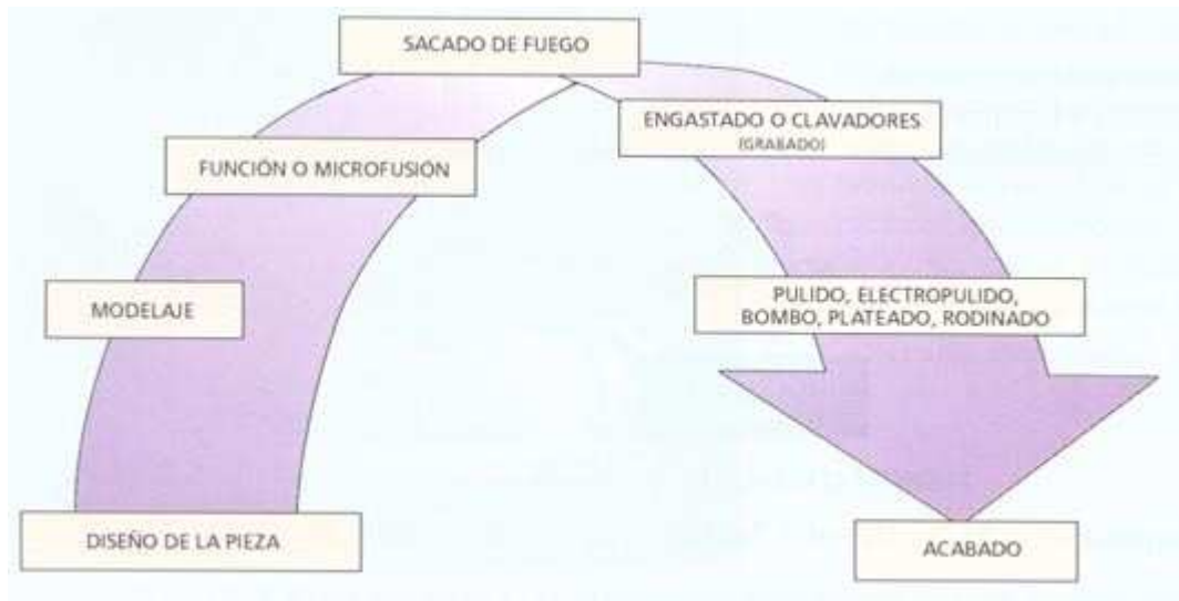
Figura 1 Esquema general del proceso productivo en joyería de oro y plata.
