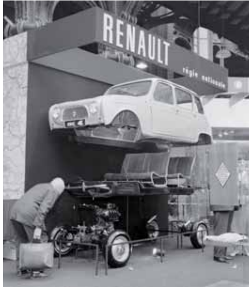
Renault 4 con carrocería chasis-plataforma
