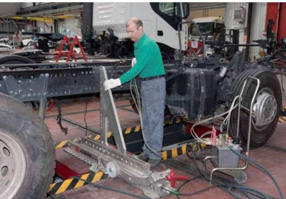
sujetamos con cadenas ambos extremos del bastidor a la bancada, y buscamos el punto exacto donde hay más pérdida. Es ahí donde realizamos un empuje vertical con un pistón hidráulico en sentido contrario al daño, siempre reforzando en el interior del bastidor, bien con placas o con pistones hidráulicos. Así evitamos que se deformen las alas, y ayudamos al alma del bastidor, a su vez, a corregir la pérdida de nivel.
