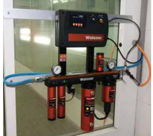
Equipo auxiliar de atemperado y filtrado del aire
