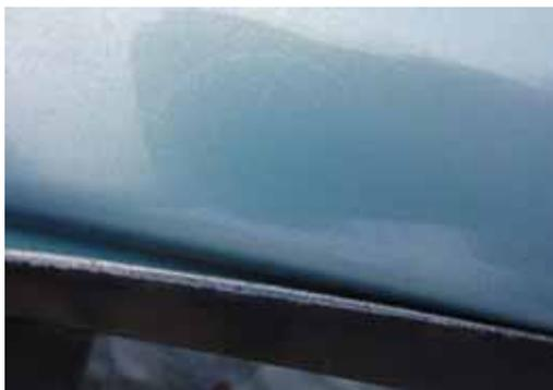
Otra parte importante del proceso de pintado, y con influencia directa sobre la aparición de defectos, es el **lijado de las superficies**, previo a la aplicación del color de acabado. Una incorrecta elección y utilización de las lijadoras, de sus órbitas de trabajo, de la dureza de sus platos y del disco abrasivo se manifestará en forma de los famosos “caracolillos” o “marcas de lija”. Y este defecto tiene una única y poco rentable solución: repetir el trabajo.
