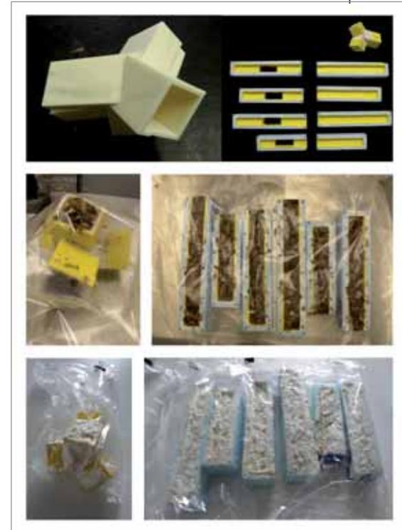
Figura 15. Moldes para módulos de topología prismática y cúbica. Parte central y brazos-ramas de molde de módulo prismático rellenas de residuo agrícola y semillas de hongo. Crecimiento de micelio en parte central y brazos-ramas de molde de módulo prismático.
