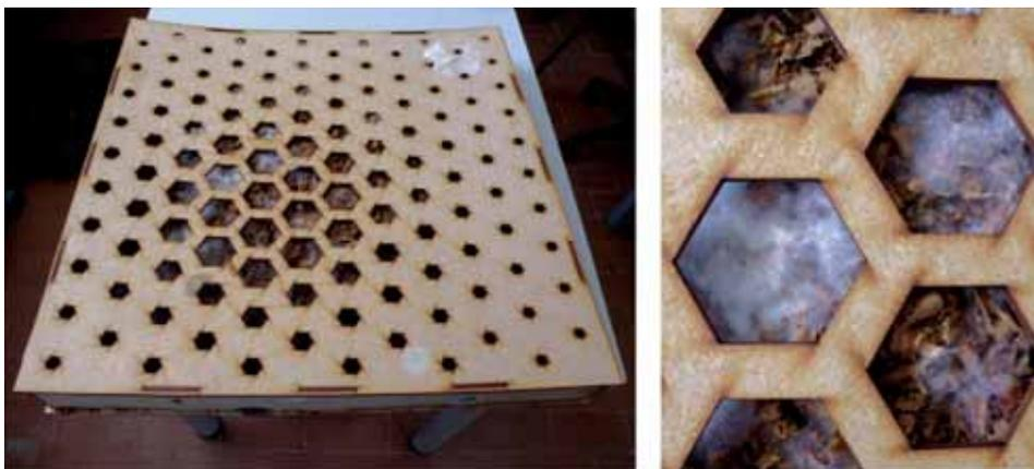
**Figura 24.** Molde de madera relleno con virutas de madera de roble y semillas de hongo de la especie *Lentinula edodes* y detalle de crecimiento de micelio de *Lentinula edodes* en molde relleno con virutas de madera de roble.
