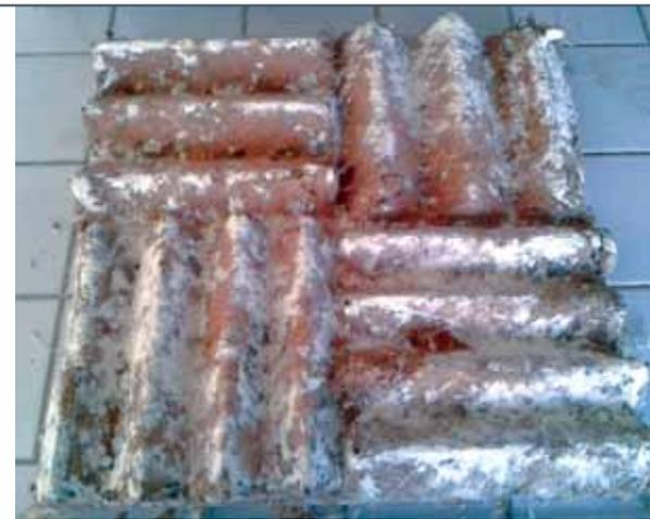
**Figura 25.** Prototipo de módulo para pared orgánica aislante crecido a partir de paja, paja triturada pasteurizada y semillas de *Pleurotus ostreatus*.
