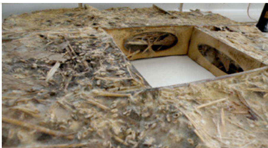
Figura 4.56. Molde relleno con paja en el que creció micelio de Pleurotus ostreatus contaminado con moho.
