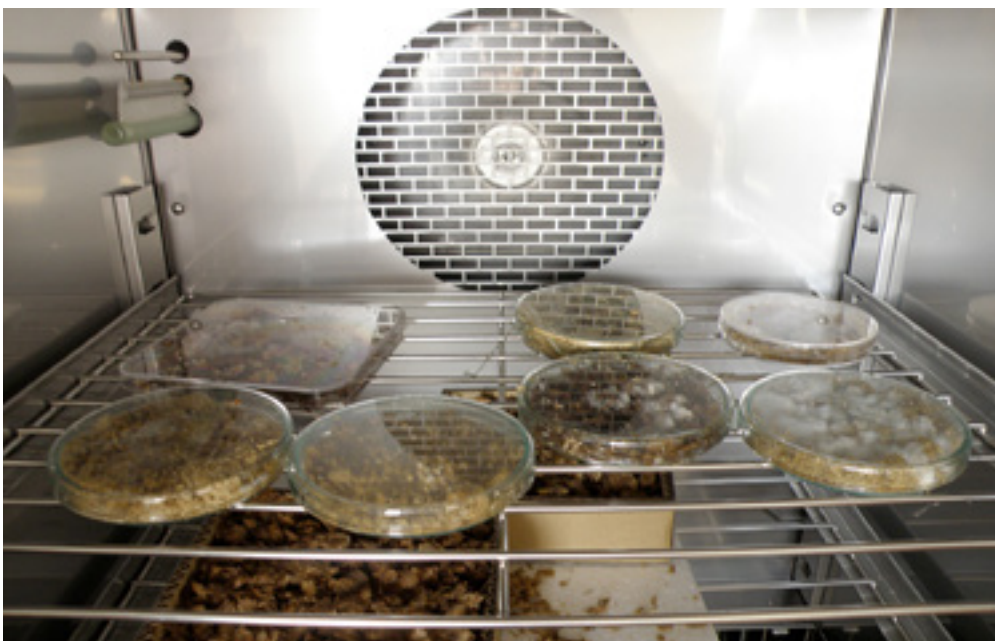
Foto 3.4. Cultivos de distintas especies de hongos sobre diferentes sustratos agrícolas dentro de cámara climática a 20°C de temperatura y a una humedad del 80%.
