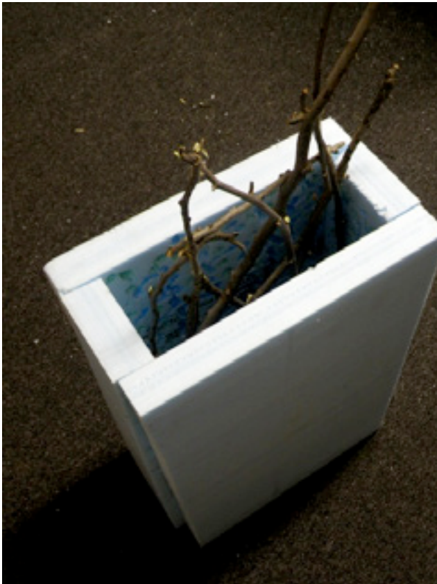
Figura 4.40. Molde y estructura de ramas para prototipo de pared orgánica aislante.
