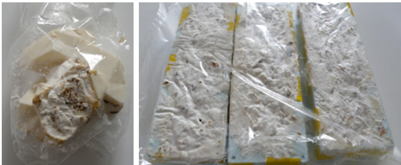
Figura 4.23. Crecimiento de micelio en parte central y brazos-ramas de molde de módulo cúbico.
