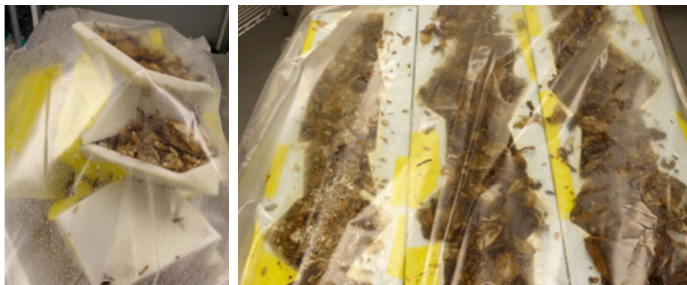
Figura 4.22. Parte central y brazos-ramas de molde de módulo cúbico rellenas de residuo agrícola y semillas de hongo.
