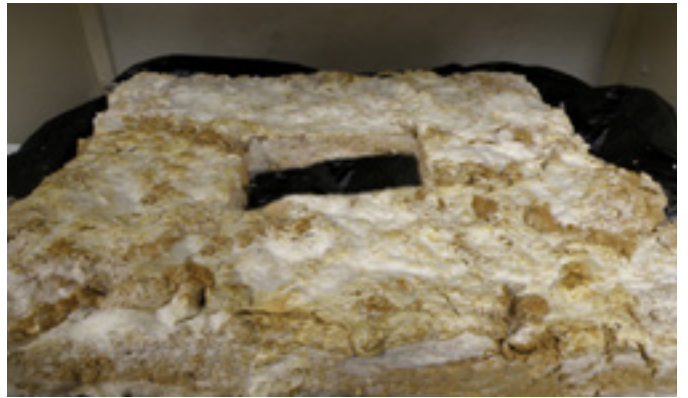
Figura 4.61. Prototipo de pared orgánica aislante crecida a partir de paja triturada pasteurizada y micelio de la especie Pleurotus ostreatus .
