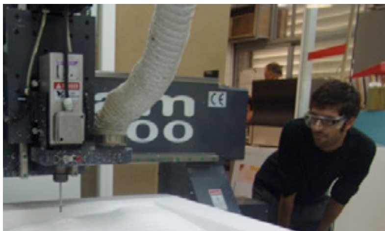
Figura 4.43. Fabricación con fresadora digital de molde para pared orgánica.
