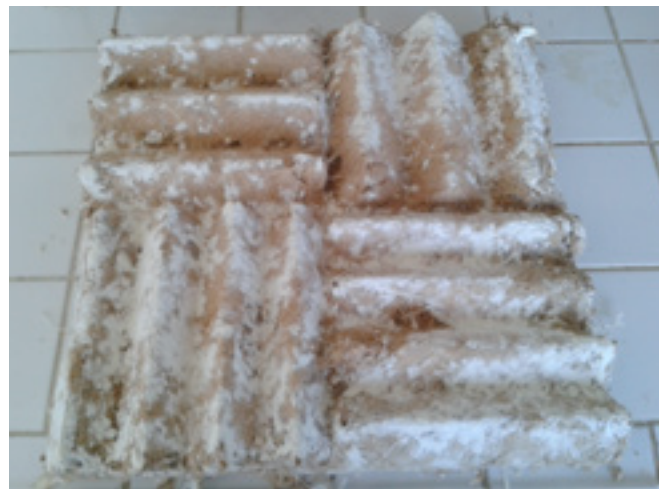
Figura 4.64. Prototipo de módulo para pared orgánica aislante crecido a partir de paja, paja triturada pasteurizada y semillas de Pleurotus ostreatus .
