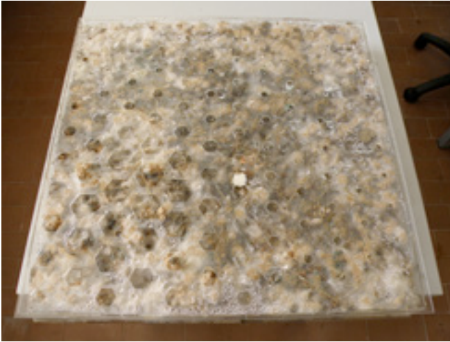
Figura 4.64. Molde de metacrilato relleno con paja triturada pasteurizada y semillas de hongo de la especie Pleurotus ostreatus .
