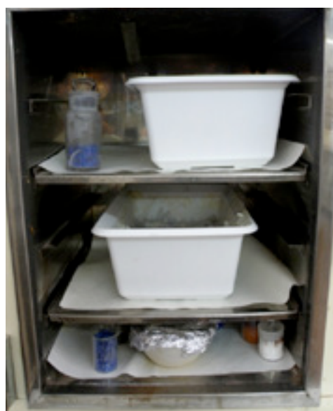
Figura 4.36. Secado en horno de prototipos para panel aislante.
