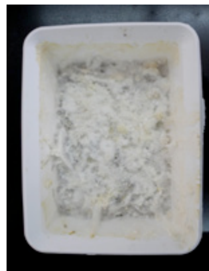
Figura 4.35. Micelio desarrollado dentro de molde para panel aislante.
