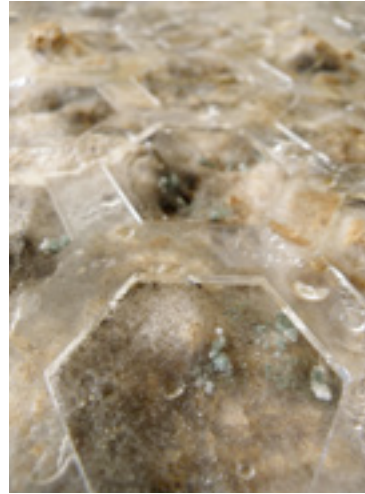
Figura 4.65. Detalle de crecimiento de micelio de Pleurotus ostreatus en molde relleno con paja triturada pasteurizada.
