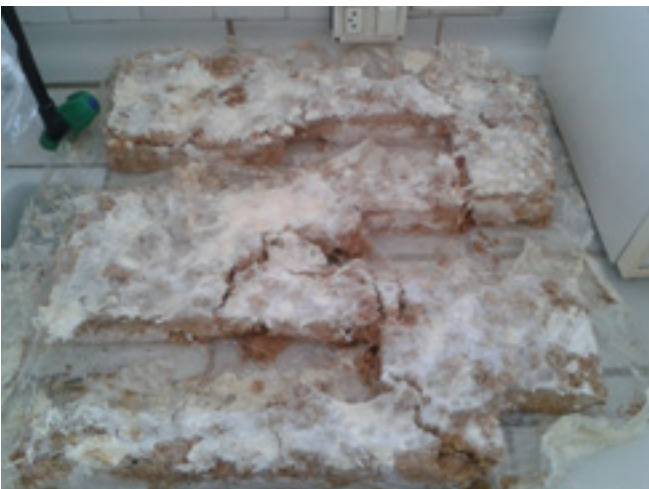
Figura 4.66. Prototipo de módulo para pared orgánica aislante crecido a partir de paja, paja triturada pasteurizada y semillas de Pleurotus ostreatus con grietas en zonas de menor sección.
