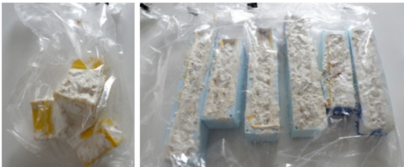
Figura 4.21. Crecimiento de micelio en parte central y brazos-ramas de molde de módulo prismático.
