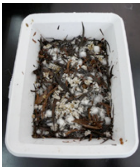
Figura 4.34. Crecimiento de micelio en molde para panel aislante.
