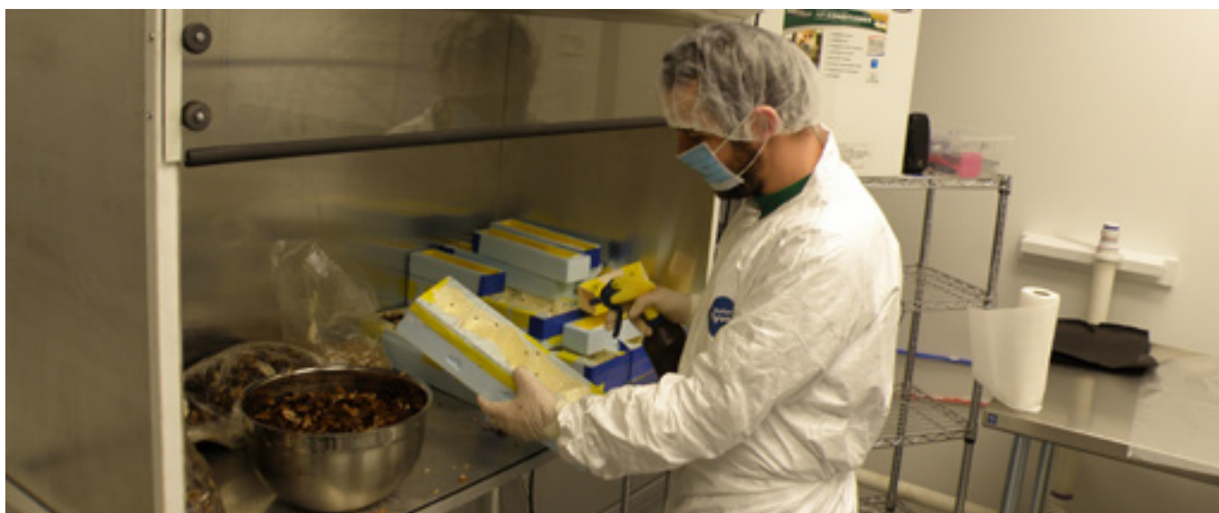
Figura 4.19. Proceso de llenado de moldes en cámara con extracción de aire.
