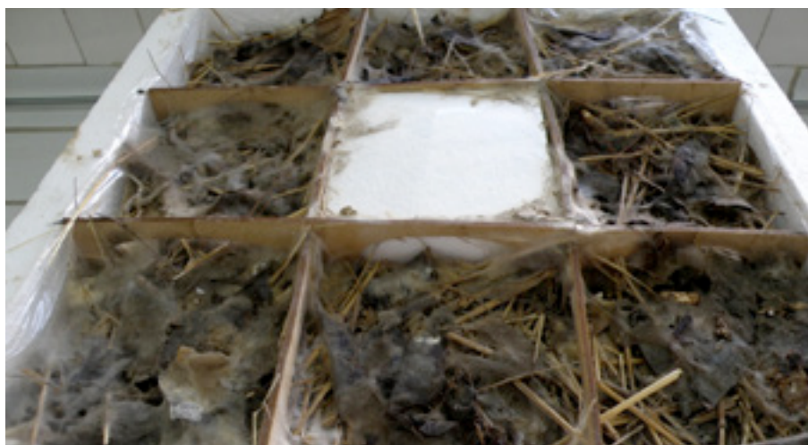
Figura 4.54. Molde relleno con hojas en el que no terminó de crecer el micelio de Pleurotus ostreatus .
