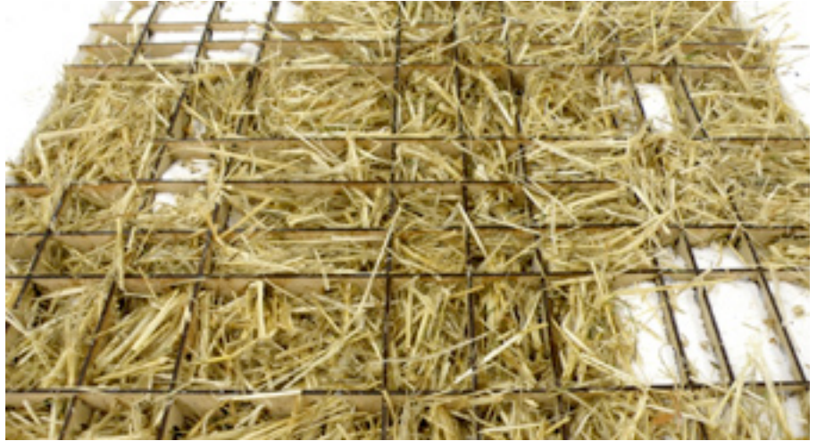
Figura 4.49. Llenado de molde con virutas de madera y semillas de Pleurotus ostreatus .
