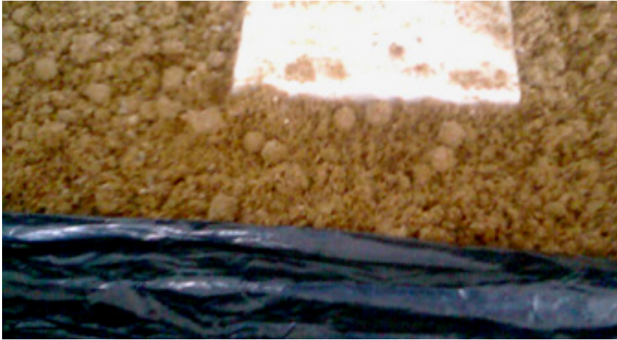
Figura 4.58. Molde relleno con paja triturada pasteurizada.
