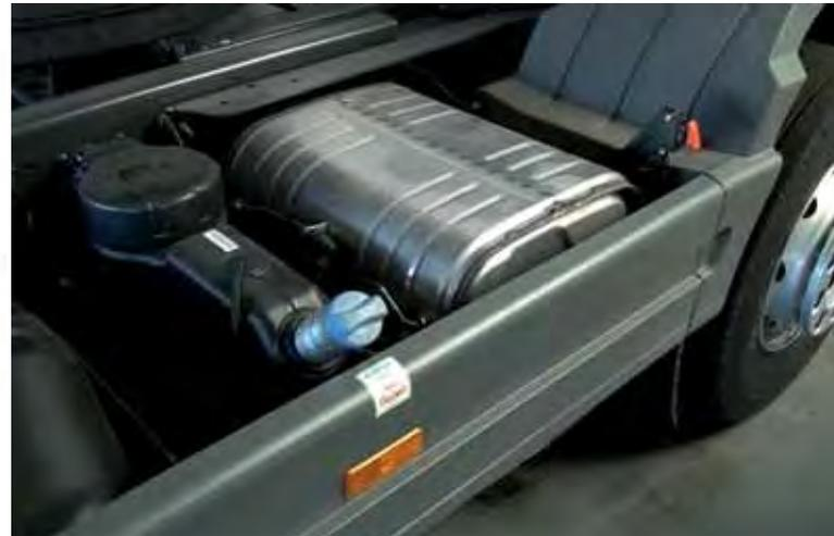
► Depósito de AdBlue y silenciador integrado-Mercedes Benz
