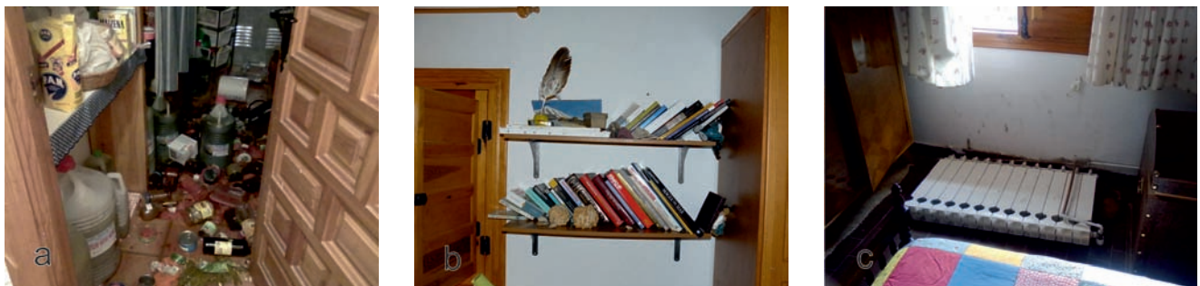
Figura 2. Durante el terremoto de Lorca de 2011 se identificaron los elementos peligrosos más característicos en una vivienda. Por ejemplo: a.- no tener armarios cerrados con pestillo, b.- elementos de estanterías que pueden caer sobre camas o sofás, y c.- elementos que por su peso pueden caer sobre personas y provocar graves heridas.
