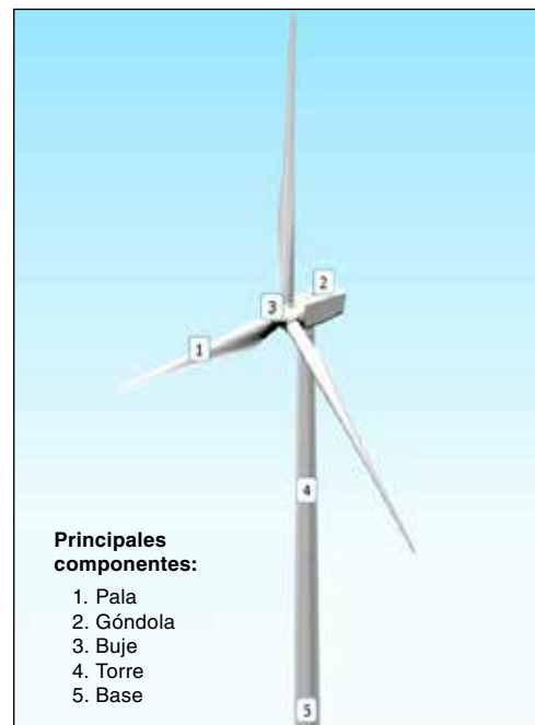
Figura 2. Partes del aerogenerador o turbina eólica
