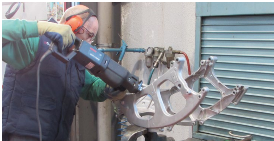
► Destrucción del chasis dañado
