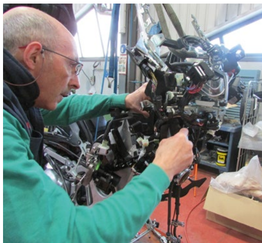
► Montaje del nuevo chasis y retroquelado
