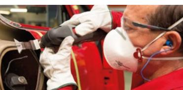
Las herramientas autónomas de Würth funcionan con batería recargable. Son ergonómicas, con recubrimiento plástico antideslizante y están ideadas para realizar diferentes trabajos en cualquier zona del taller o, incluso, en la calle, debido a la autonomía que aportan las baterías de iones de litio de 2.0 Ah.
