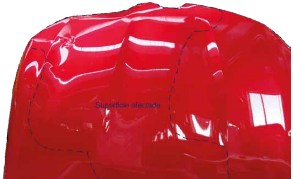
► Superficie dañada de capó delantero ¿Reparar o sustituir?
