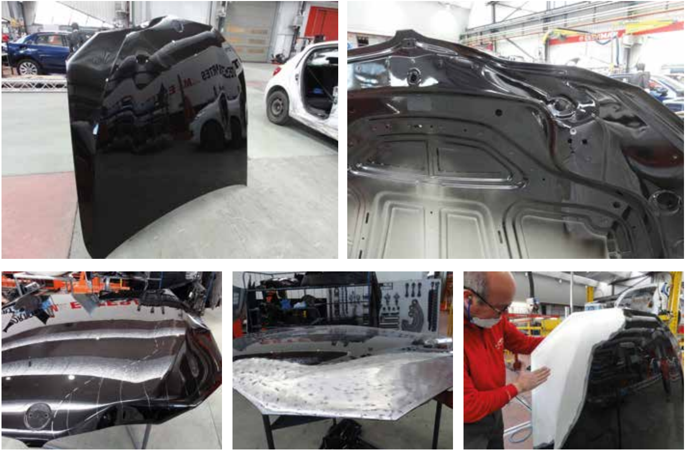
► Proceso de reparación del capó delantero del BMW serie 5 (aluminio)
