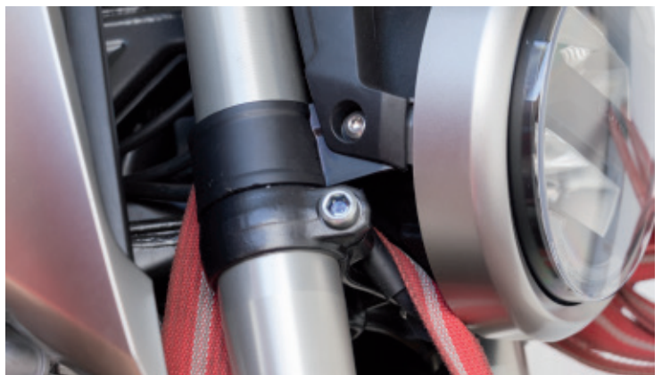
► La cinta de amarre puede ocasionar daños en la tubería de frenos
