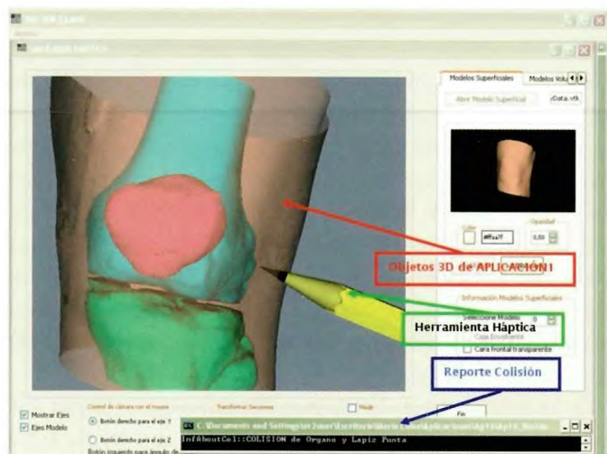
Fig. 4. APLICACIÓN2: Simulador con capacidades hápticas.
