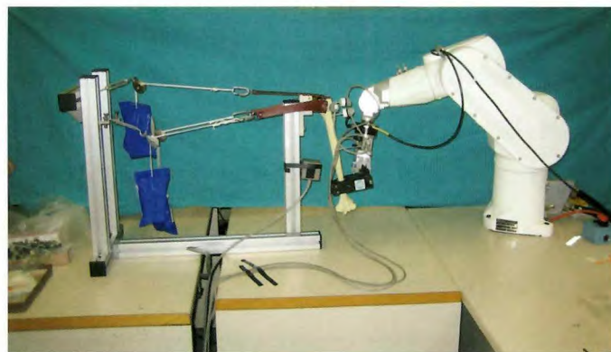
Fig. 1. Sistema de fijación para el hueso sintético que simula la glenoides y permite al robot reproducir los movimientos de rehabilitación de la articulación glenohumeral.
