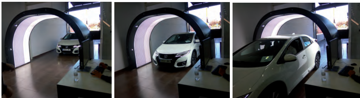
El equipo AtoSCAN detecta y contabiliza los daños de granizo, mediante un escáner, en solo 10 segundos
