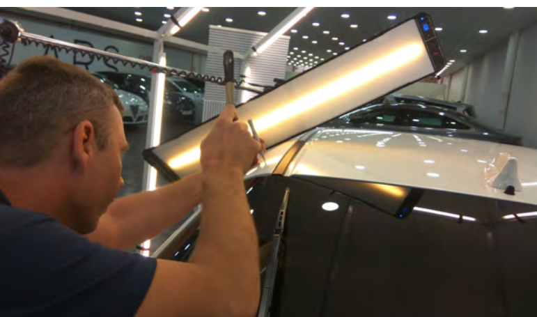
Técnica de reparación de daños por granizo sin dañar la pintura
