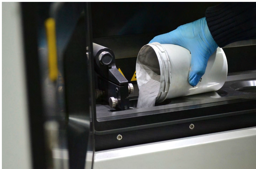
■ Figura 11 ■ Cargado de polvo metálico en una impresora de sinterización láser
