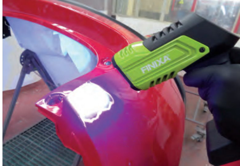
Secado y curado por radiación ultravioleta
