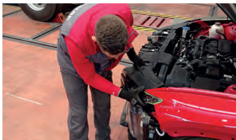
Desmontaje de la óptica delantera
