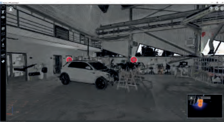
Nube de puntos del taller en escala de grises para ver la propagación del incendio o cuando no hay luz natural
