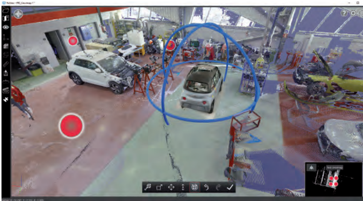
Recreación del escenario introduciendo un vehículo escaneado en 3D en la nube de puntos
