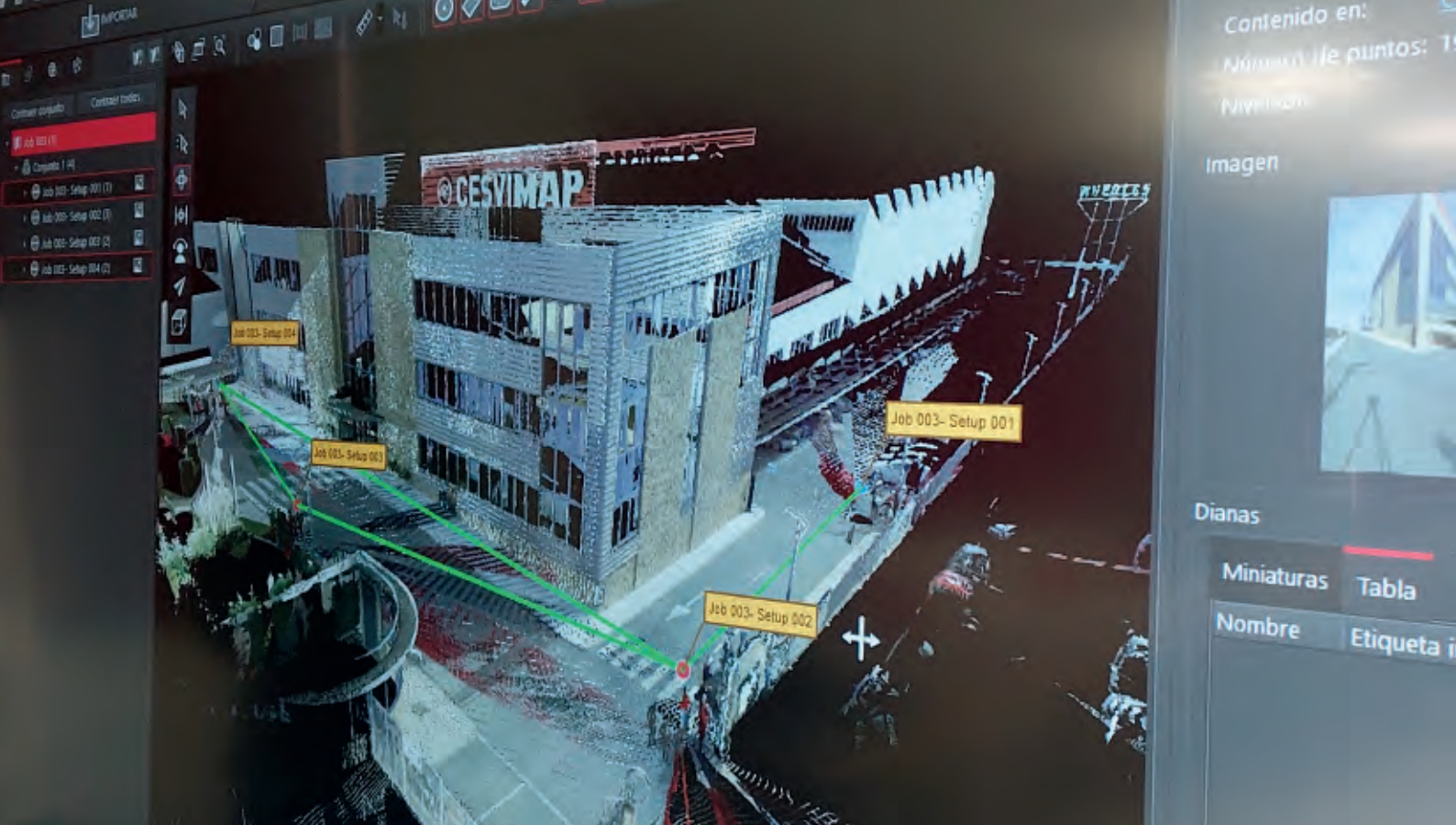
Nube de puntos obtenida del escaneo de la fachada de CESVIMAP
