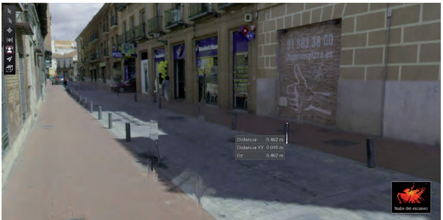
Medición de la altura de uno de los bolardos contra los que impactó el vehículo
