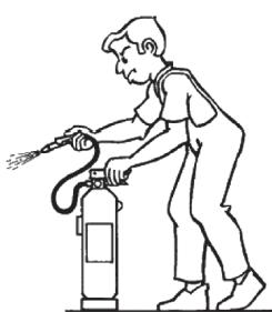
Presiona la palanca de la cabeza del extintor, realizando una pequeña descarga de comprobación.
