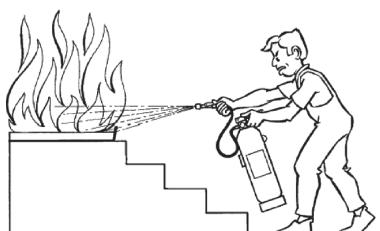
Dirige el chorro a la base de las llamas con movimiento de barrido. En caso de incendio de líquidos, proyecta superficialmente el agente extintor efectuando un barrido evitando que la propia presión de impulsión provoque derrame del líquido incendiado. Avanzar lentamente hacia el fuego hasta un máximo aproximado de un metro.
