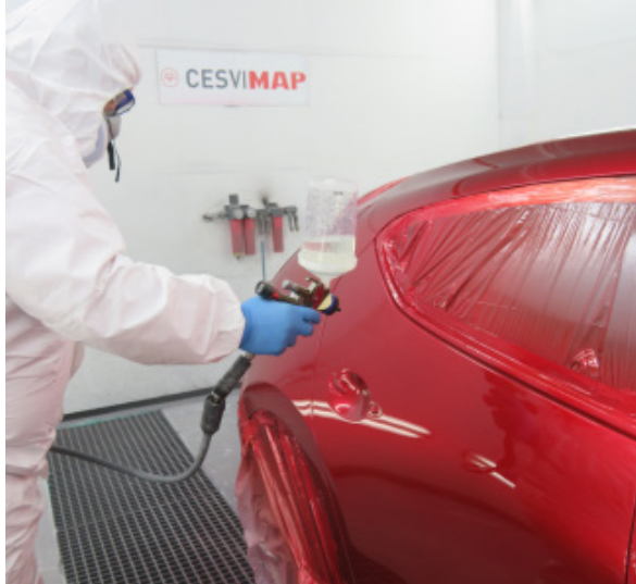
Aplicación de la capa de barniz en un tricapa
