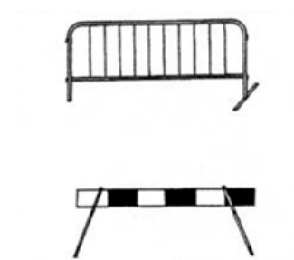
Ilustración 38 Vallado de señalización. Fuente: : http://www.ibermutuamur.es/
