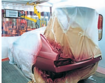
Aplicación del acabado
