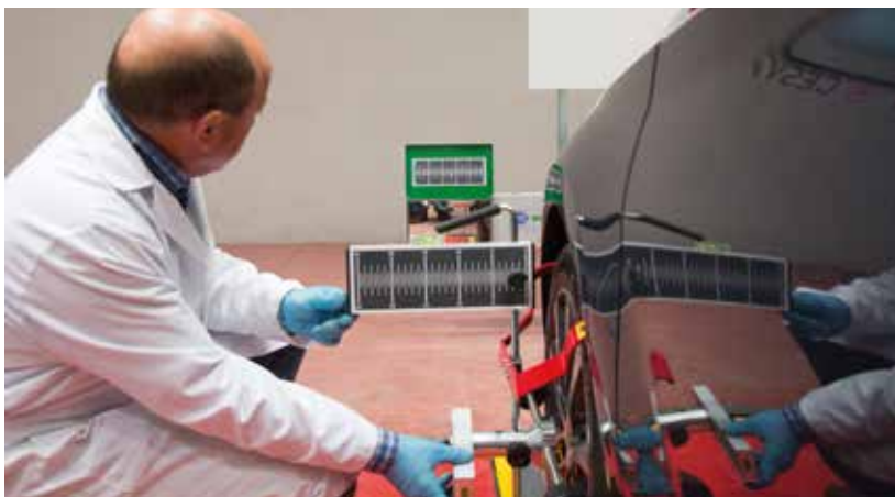
► Calibración estática de una cámara tras la sustitución del parabrisas
