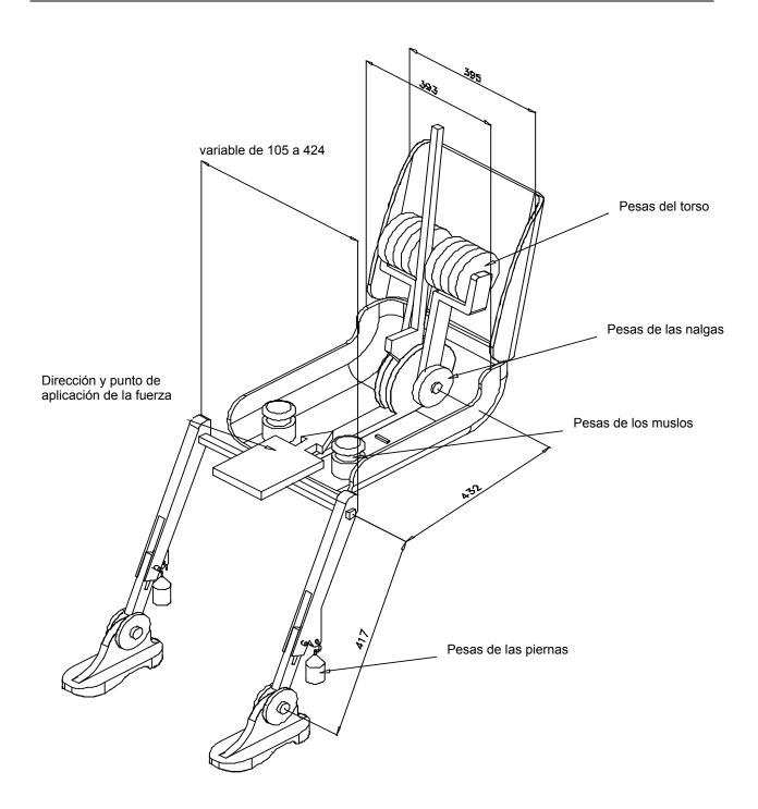
Figura 2: Dimensiones de los elementos del maniquí 3-D H y distribución de las cargas
