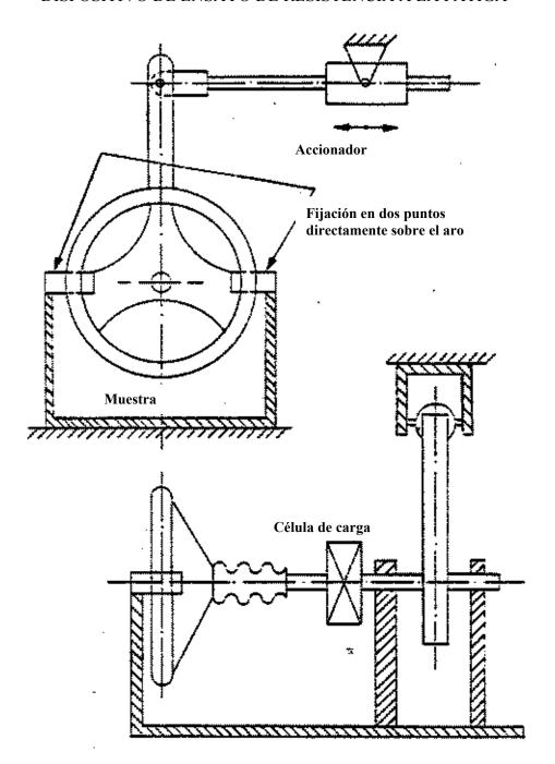
Ejemplo de dispositivo de ensayo de resistencia a la fatiga
