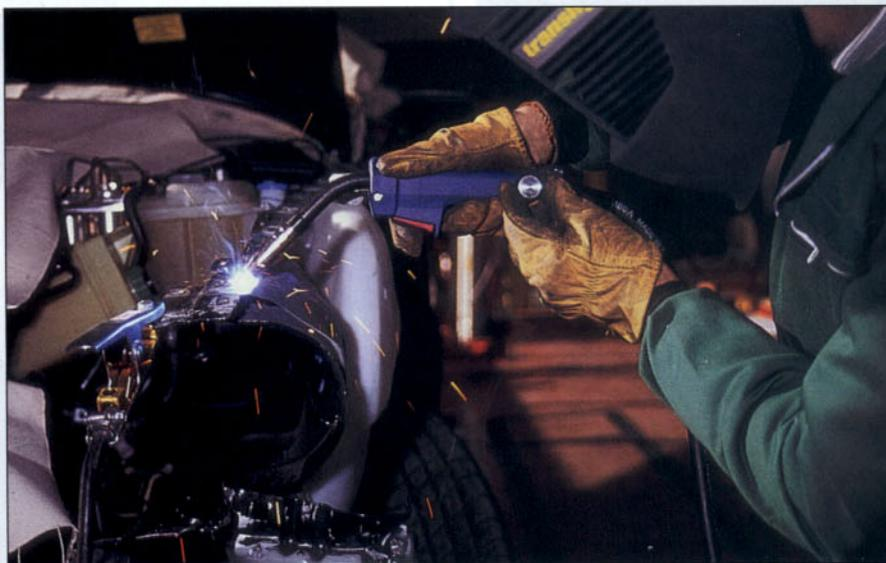
Reajuste de la tensión durante la soldadura.
