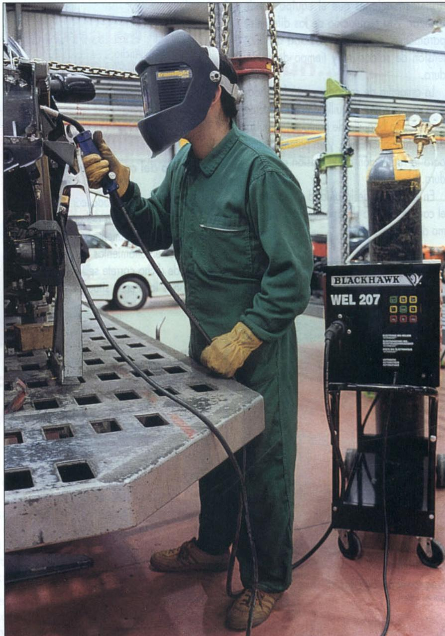
**E**ste equipo está indicado para la realización de soldaduras por arco eléctrico bajo gas protector (MIG/MAG) en acero y aluminio. Debido a sus características técnicas, resulta apropiado para
