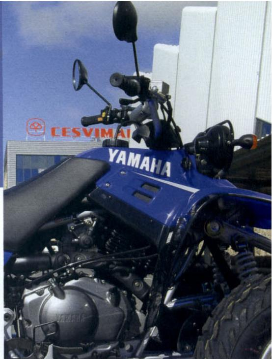
combustible. El chasis, de diseño tubular, normalmente está fabricado con acero. Sobre él se montan el resto de los elementos.
