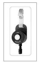
Figura 5. Muestreador IOM multifracción
