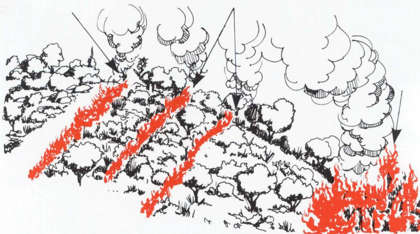
Fig. 14. Contrafuegos auxiliares. El contrafuego, a veces, no avanza fácilmente hacia el incendio. Se puede provocar quemas auxiliares que atraigan al contrafuego.
