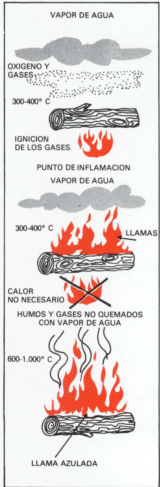
COMBUSTION DE LOS GASES
