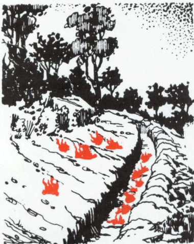
Fig. 18. Las fajas de apoyo que se abren a media ladera se completan con zanjas capaces de retener los materiales en ignición que puedan bajar rodando.
