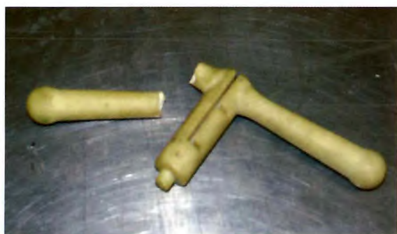
Fig. 4. Prototipo A fracturado.
