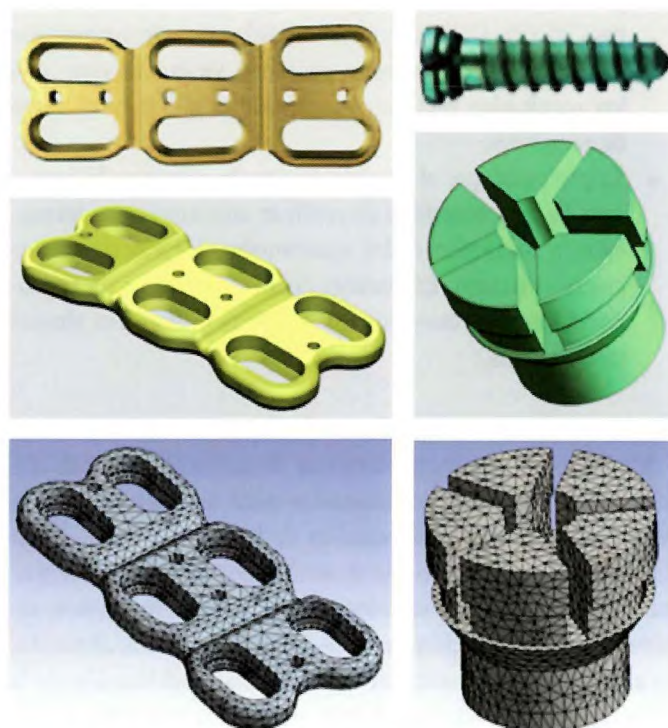
Fig. 2. Modelización secuencial de la instrumentación a partir de la placa dinámica ABC (izquierda) y tornillo unicortical (derecha) empleados en la generación del MEF, modelados en «Solidworks» como paso intermedio antes de pasarlos a modelos de elementos finitos.
