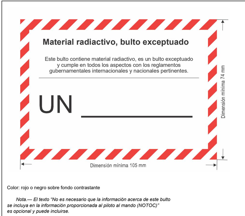
Figura 5-33. Material radiactivo, bulto exceptuado
